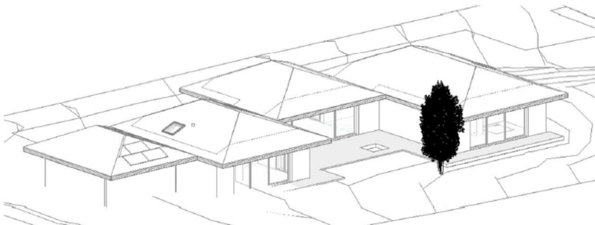
Le projet prévoit la construction d'une villa de haut standing située à Dully. La maison comporte un nombre important de surfaces vitrées, un système de protection solaire contrôlé par commande électrique a donc été nécessaire. Des panneaux photovoltaïques ont également été installés en toiture pour permettre la production d'environ 20% d'énergie électrique.
